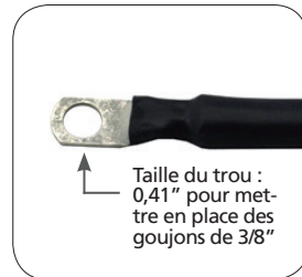
Fig. 3,14. Terminaison câble négatif
